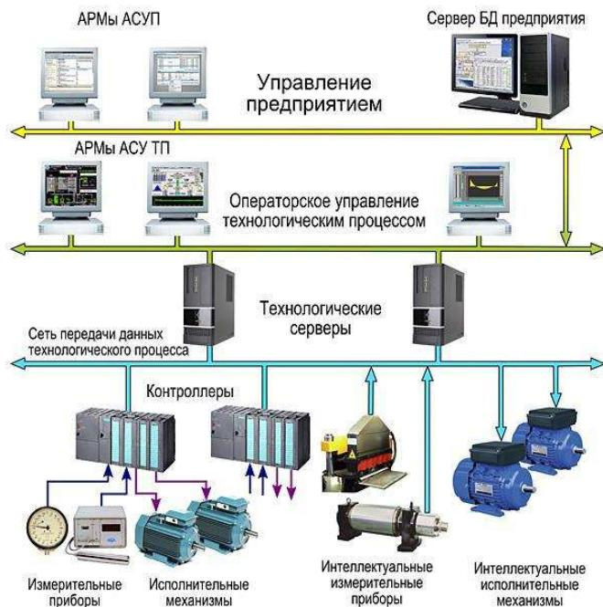
В рамках работ по разработке, сопровождению и эксплуатации программно-технических комплексов АСУТП нашими специалистами выполняются:
