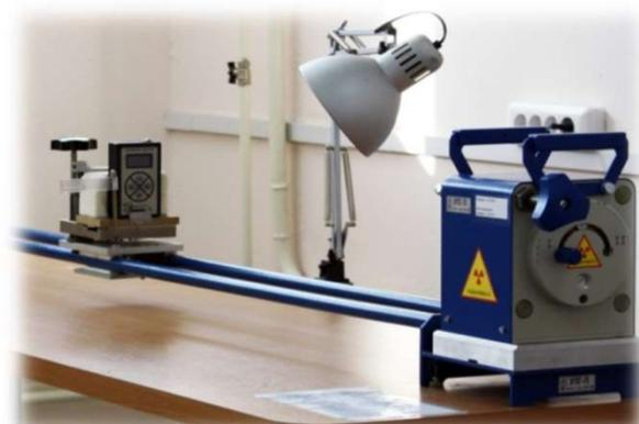
Ремонт и поверка (калибровка) средств измерений ионизирующих излучений осуществляется как на территории ЦЛ КИПиА УАП, так и по месту эксплуатации поверяемых средств измерений с использованием возимых эталонов - эталонных источников. Служба имеет спец. транспорт для перевозки источников ионизирующего излучения.
