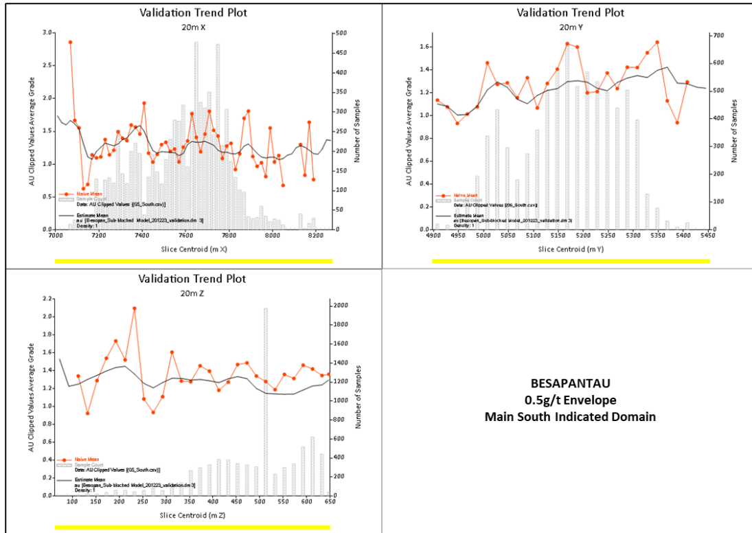
Рис. 3.41: Пример графика контрольной проверки содержаний методом «полос» для Бесапантау (черным показана кривая значений проинтерполированных содержаний методом ординарного кригинга, красным – кривая исходных содержаний композитов)
