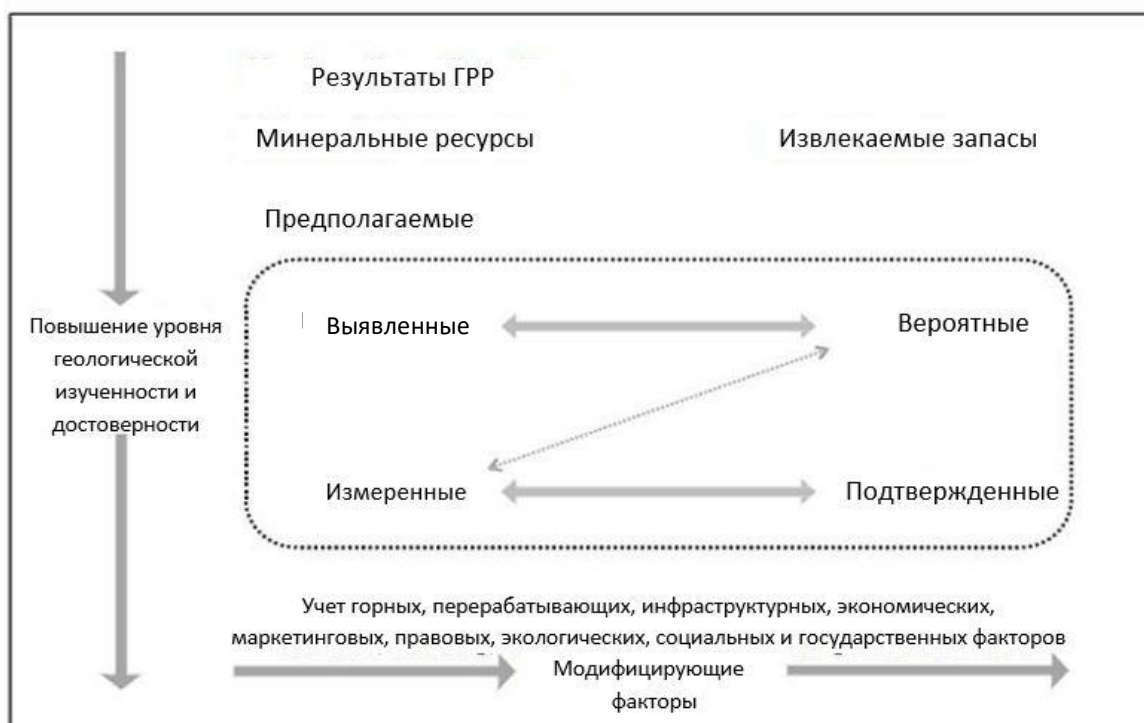
Рис. 4.1: Схема преобразования минеральных ресурсов в извлекаемые запасы по категориям (JORC 2012)
